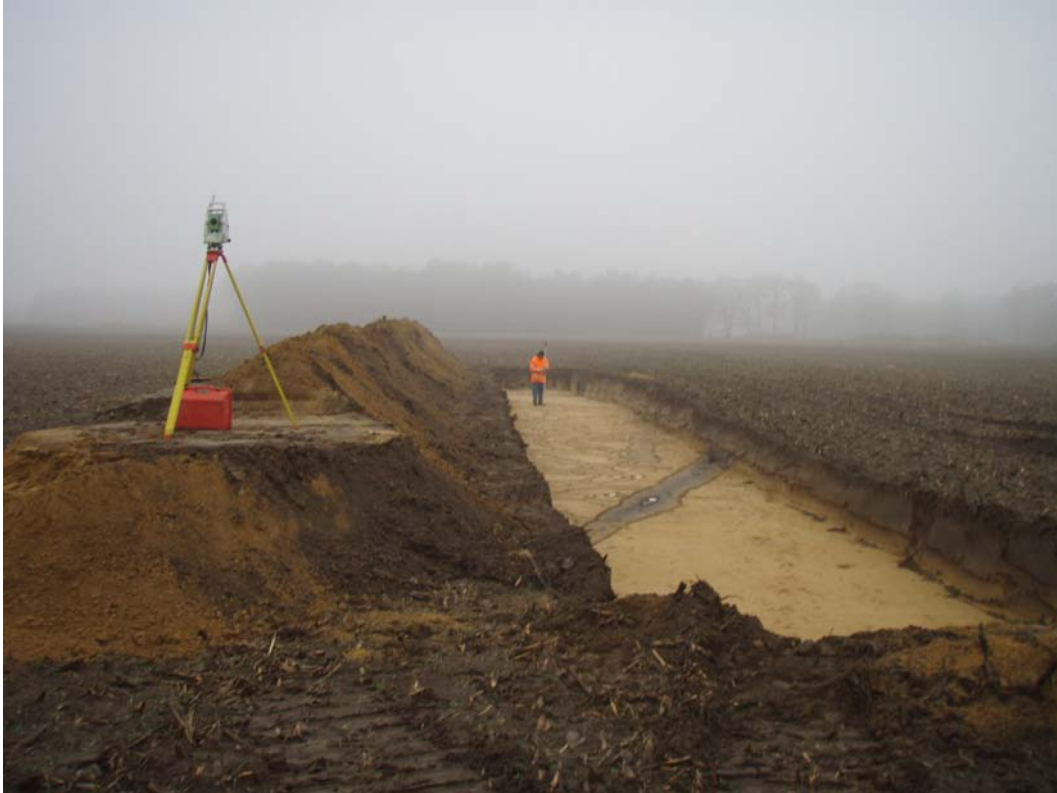
Afb. 2.1. Het inmeten van de grondsporen met behulp van een robotic Total Station.
